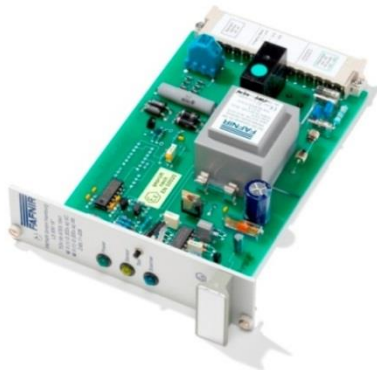
Abbildung 1.4l: Messumformer LS 500 19" im Europakartenformat
