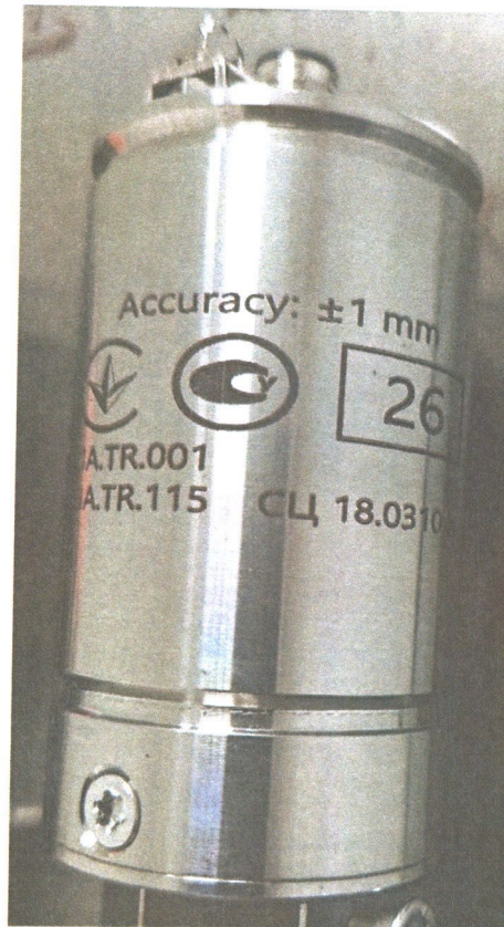
Фото 12 Зовнішній вигляд маркування точнісної характеристики (бокова поверхня голови зонду)
