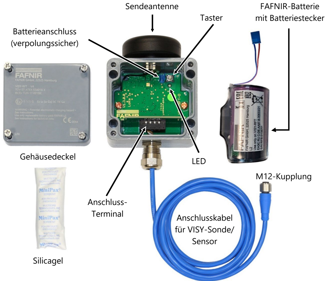
Abbildung 3: Sender VISY-RFT mit abgenommenem Deckel
