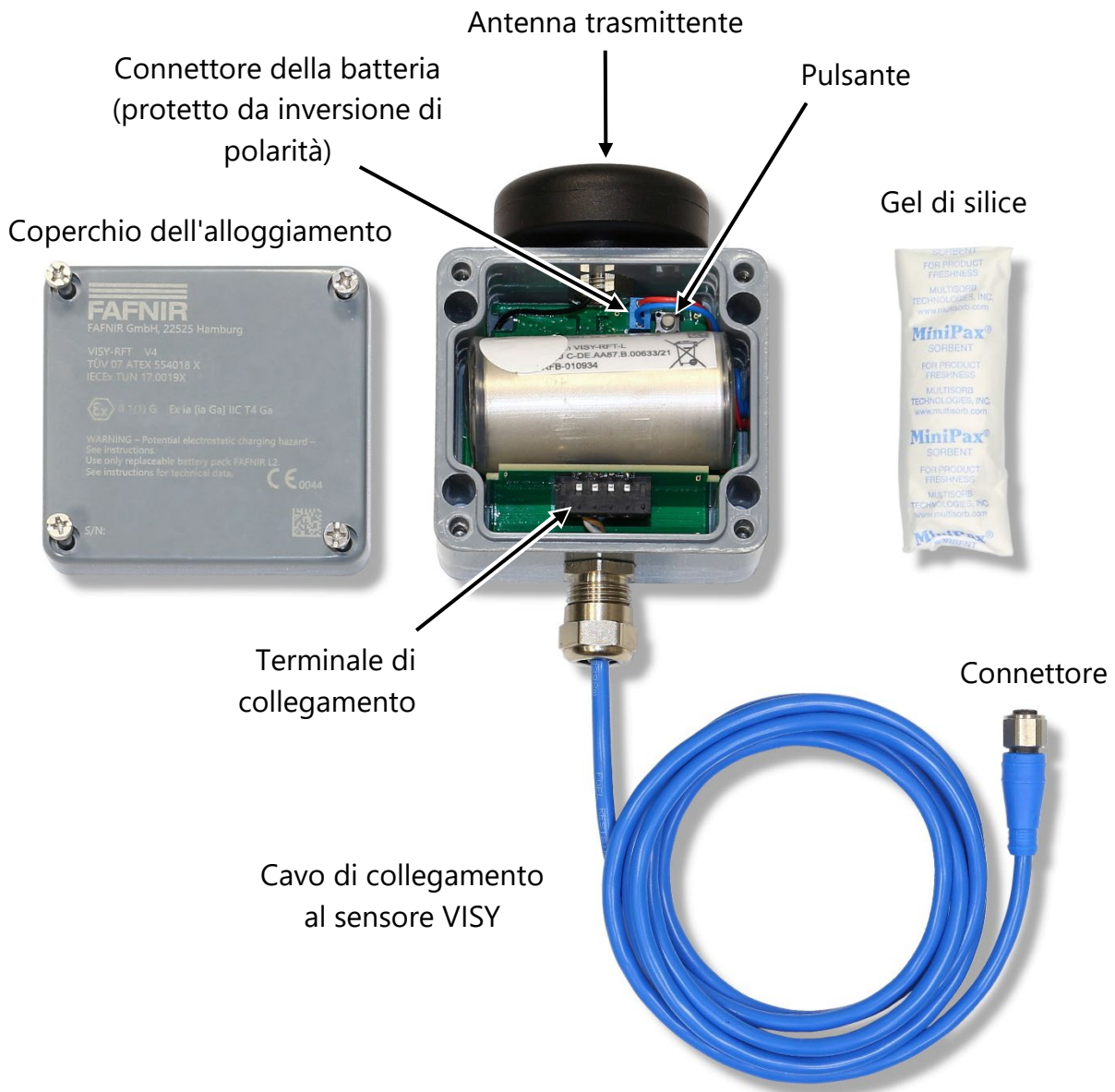
Figura 1: Trasmettitore VISY-RFT V4 con coperchio rimosso
