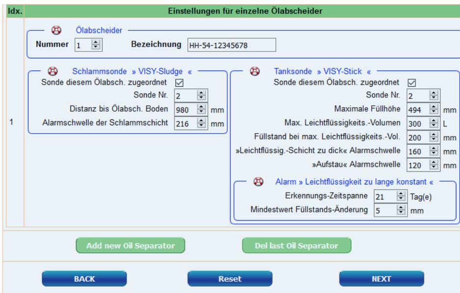
Soll kein weiterer Ölabscheider hinzugefügt werden, dann die Taste „**NEXT**“ drücken:
