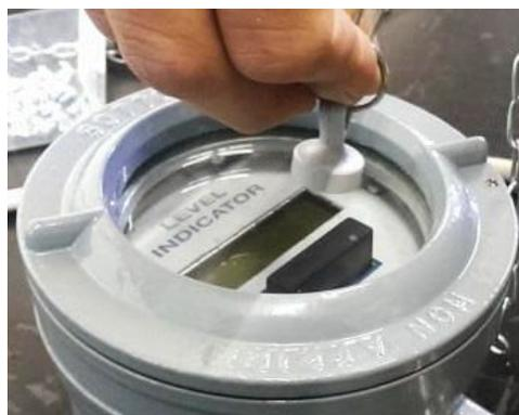
Figura 2: Utilizzo con l'ausilio del magnete
