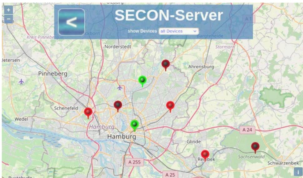
Die Farbe der Nadel zeigt den Status der Geräte an: grün = OK, gelb = Warnung, rot = Alarm. Mit Klick (linke Maustaste) auf eine Nadel wird die zugehörige Station in der Kompaktansicht mit den aktuellen Messwerten und Alarmen angezeigt.
