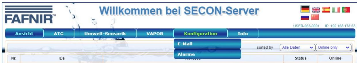
Im Menü „Konfiguration“ wird die Alarm-Benachrichtigung per E-Mail konfiguriert. Der Zugang zum Menü ist passwortgeschützt.
