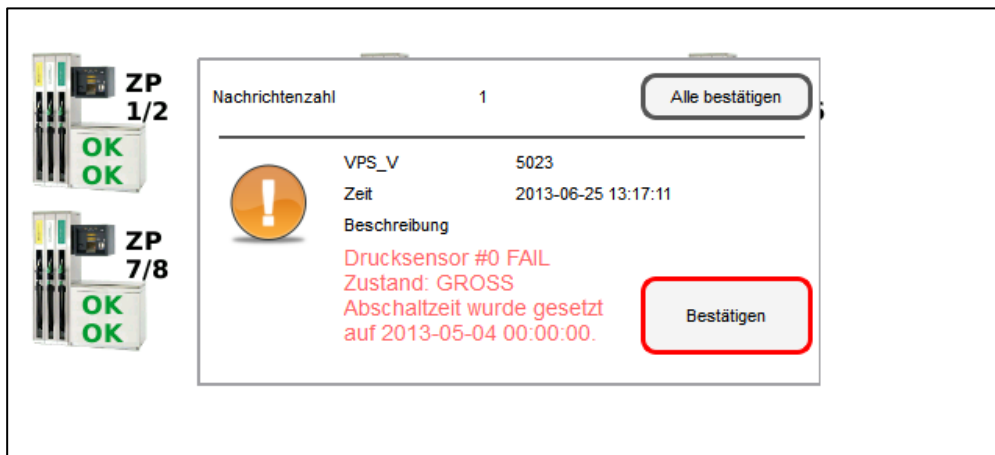
Alarmer und Abschaltung SECON-Client (Bilderserie)
