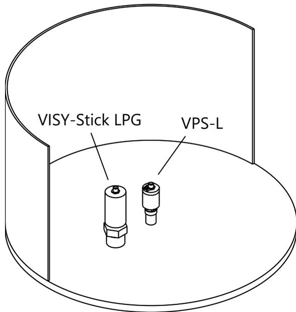
Abbildung 3: Einbau in Domdeckel
