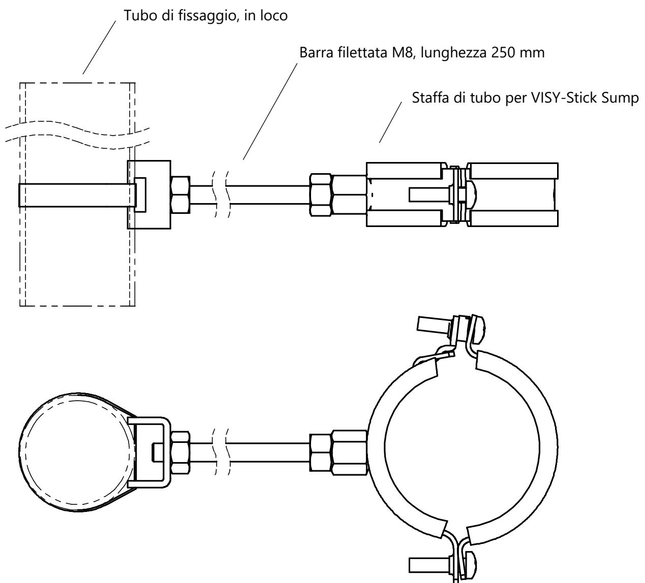
Figura 16: Kit d'installazione per VISY-Stick Sump
