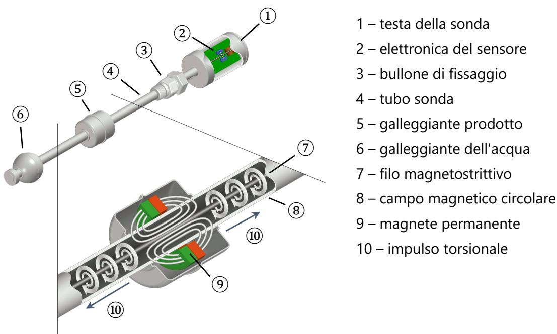
Figura 1: Funzionamento del principio di misurazione magnetostrettivo
