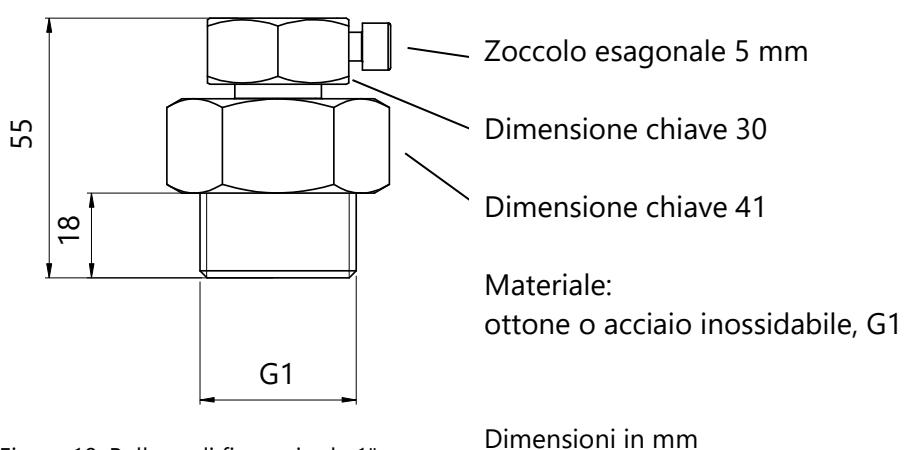
Figura 18: Bullone di fissaggio da 1"
