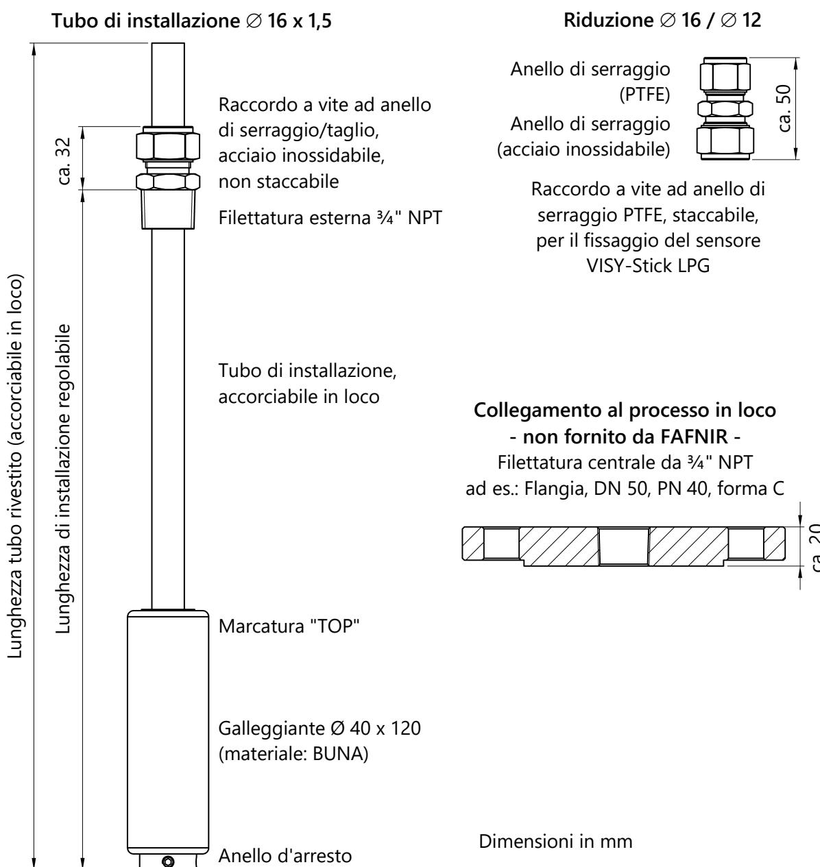
Figura 17: Kit d'installazione GLP variabile per serbatoi di gas liquido
