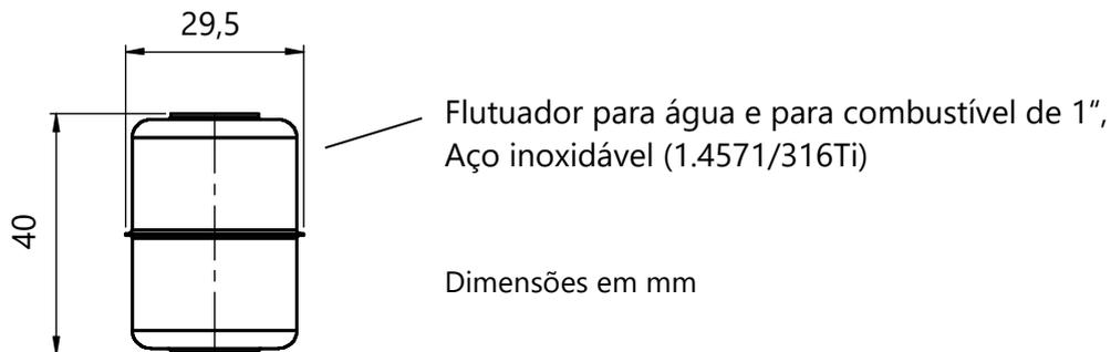
Figura 19: Flutuador para água e para combustível de 1"
