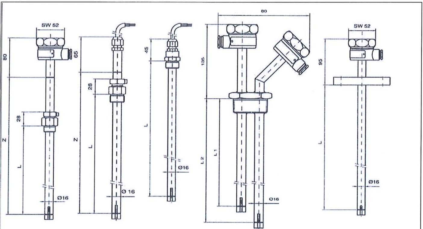
Schematische Darstellung der Überfüllsicherung
