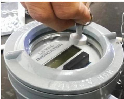
Figure 2 : Commande à l'aide de l'aimant
