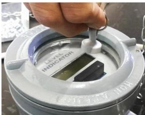
Abbildung 2: Bedienung mit Hilfe des Magneten
