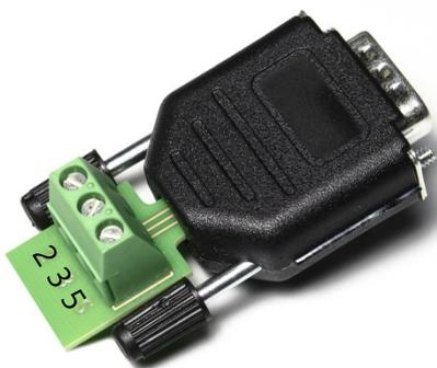
Abbildung 6: RS-232 Adapter zum Anschluss an das VI-4 Board
