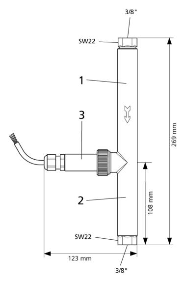
Image 1: Capteur de mesure VAPORIX-Flow
