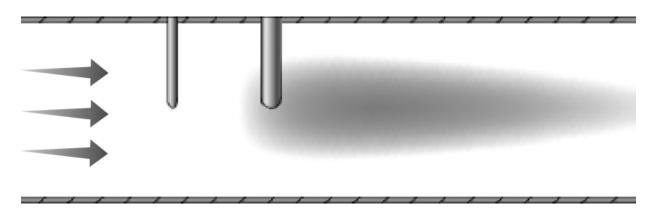
Image 2: Principe de fonctionnement du VAPORIX-Flow
