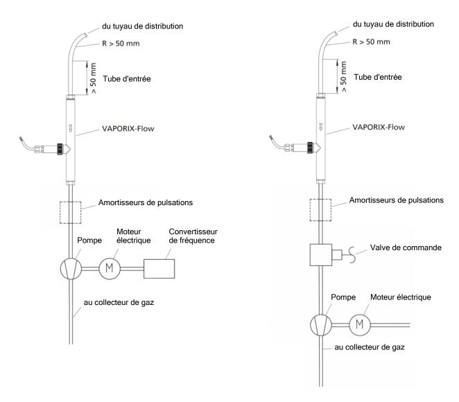
Image 3: Exemples - Conditions de montage du VAPORIX-Flow
