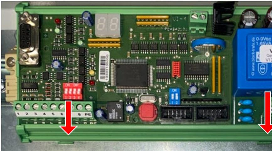
Abbildung 7: Halterung der VI-4 Platine
