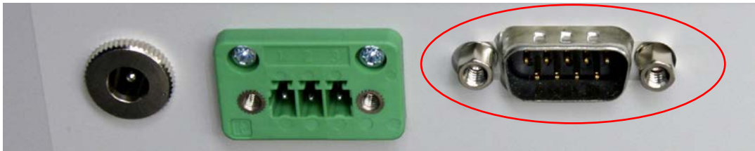
Abbildung 7: RS-232 Schnittstelle des SECONs
