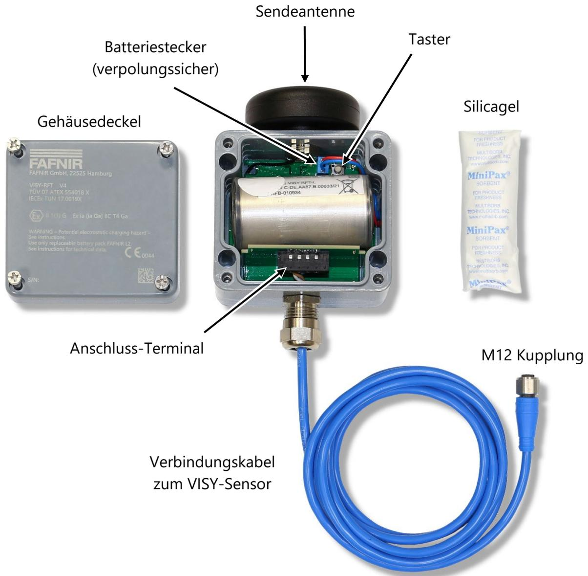
Abbildung 1: VISY-RFT V4 Sendemodul mit abgenommenem Deckel
