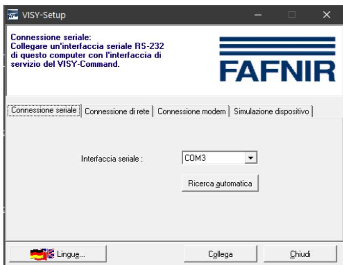
Figura 2: finestra di selezione per la comunicazione con il VISY-Command
