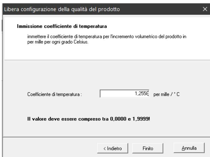
Figura 17: immissione coefficiente di temperatura
