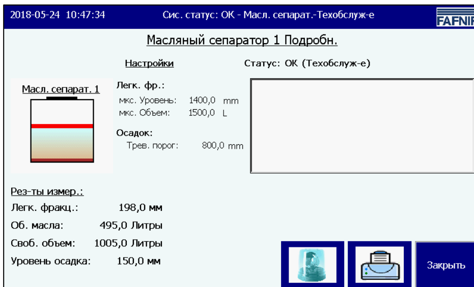
Рис. 31: Масляный сепаратор на основе VISY-Stick, детали
