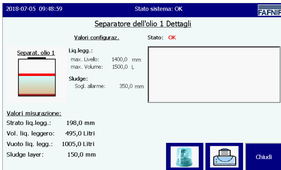
Figura 31: Separatore d'olio basato su VISY-Stick, dettagli
