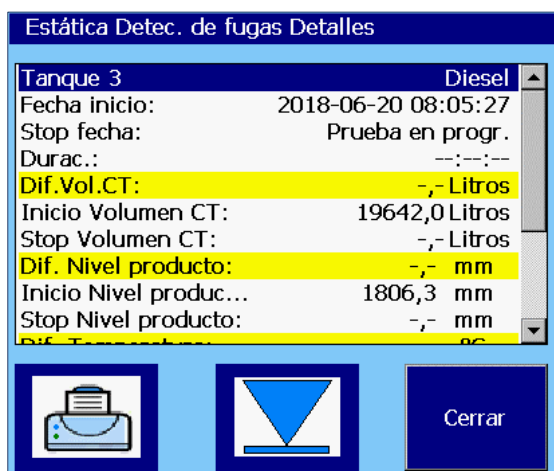
Figura 10: Detección de fugas estáticas, no finalizado
