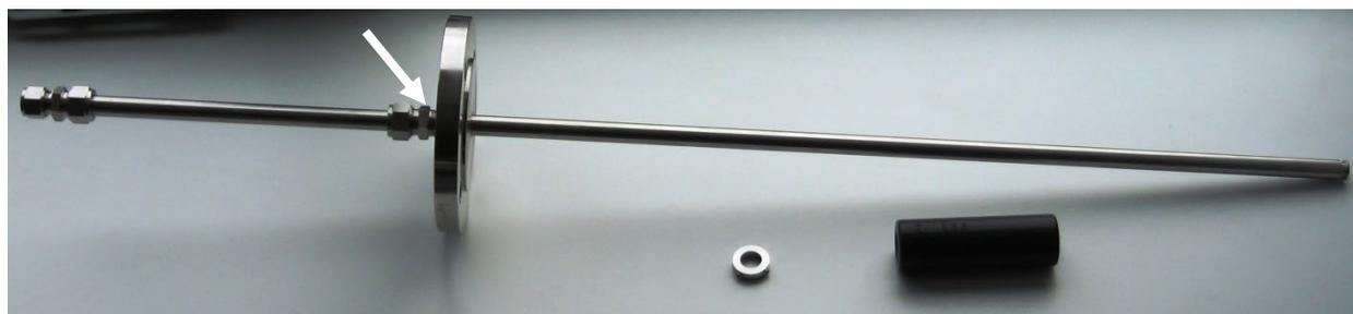
**2.4 Stecken Sie den Schwimmer auf das Mantelrohr und montieren Sie den Stelling**
