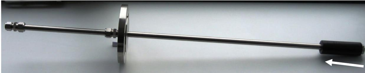
**2.5 Führen Sie das Mantelrohr in die Tanköffnung und fixieren den Flansch am Tank**
