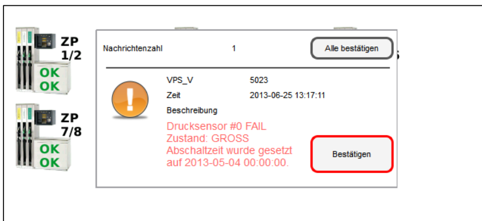
Alarmer und Abschaltung SECON-Client (Bilderserie)
