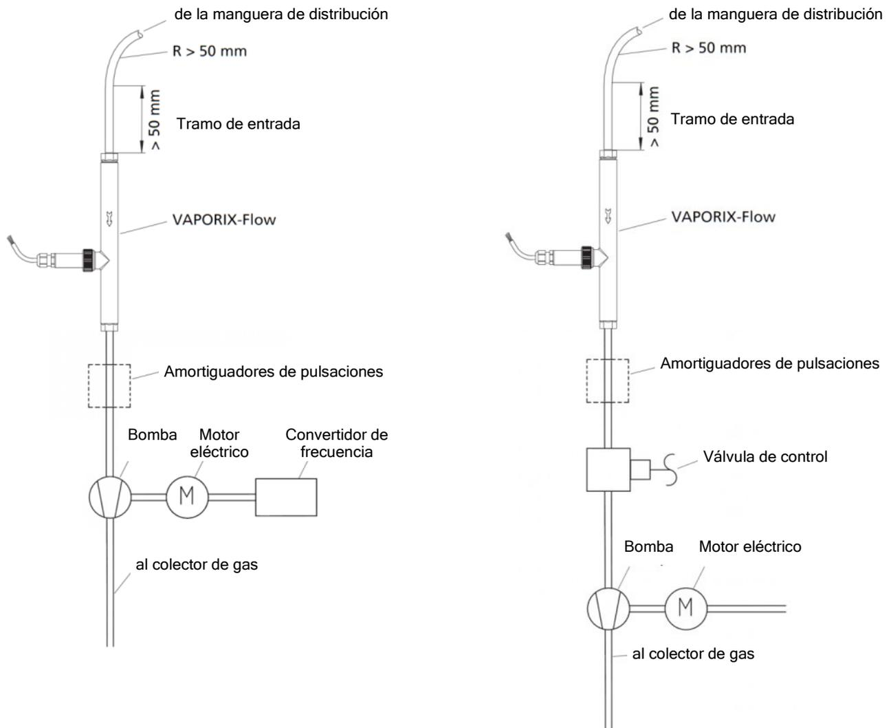
Figura 3: Ejemplos - Entorno para instalar VAPORIX-Flow
