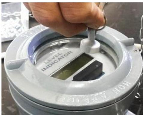
Abbildung 2: Bedienung mit Hilfe des Magneten
