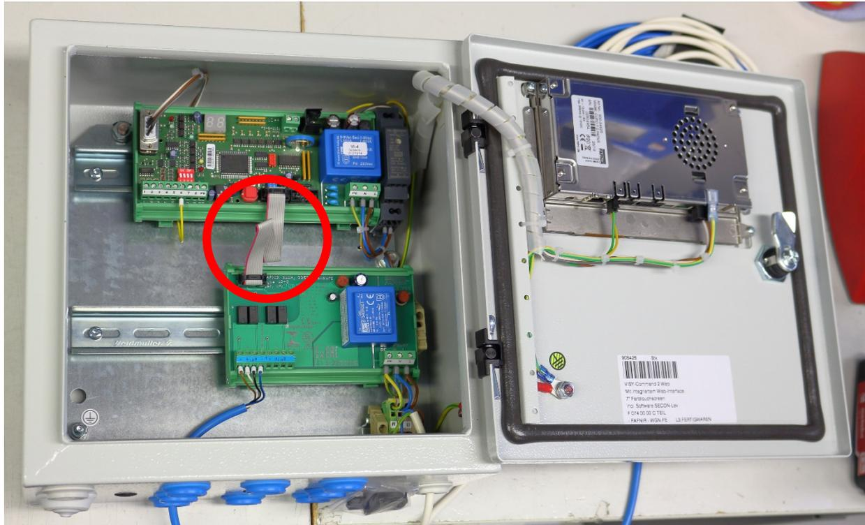
(3) **Klettband der Galvanischen Trennung** (siehe Lieferumfang) mittig zwischen dem VI-4 und VP Platine aufkleben.
