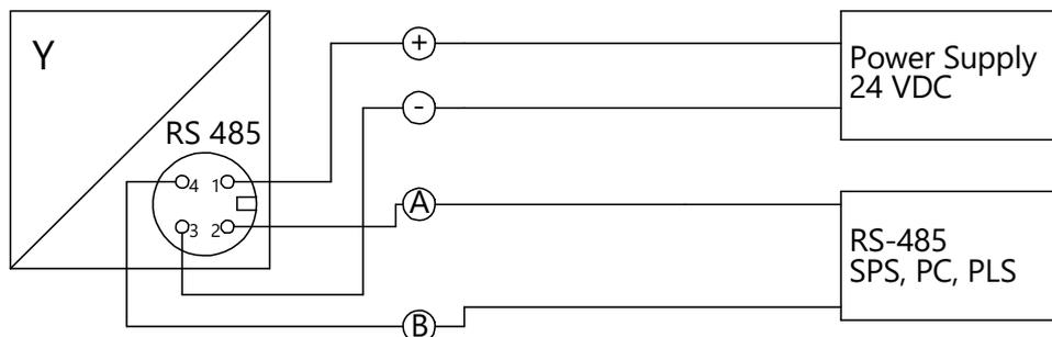
Figura 7: Schema elettrico per TORRIX RS485
