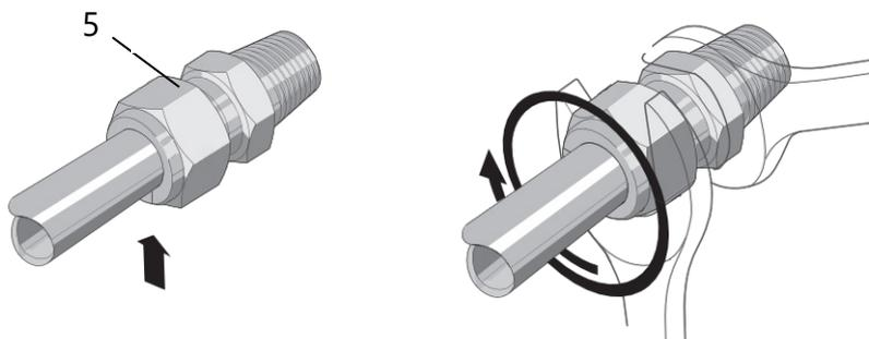
Figura 4: Fissaggio del raccordo con anello di serraggio
