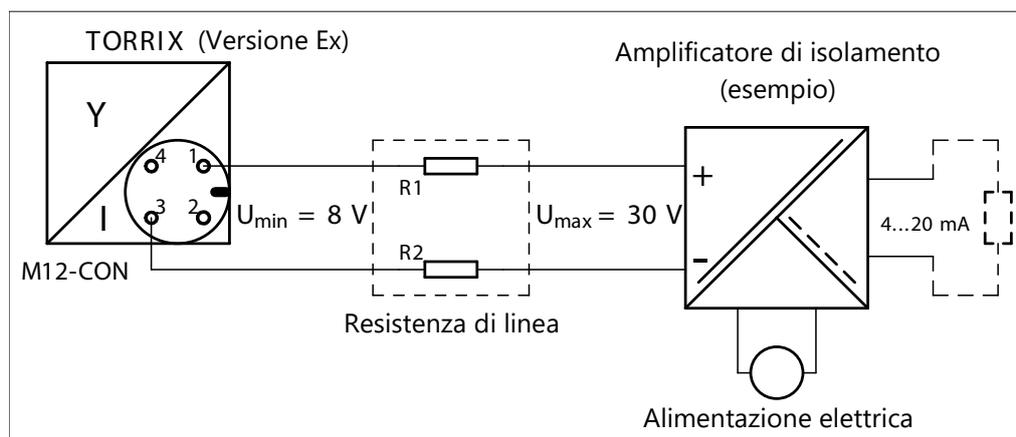
Figura 6: Schema elettrico per TORRIX Ex C
