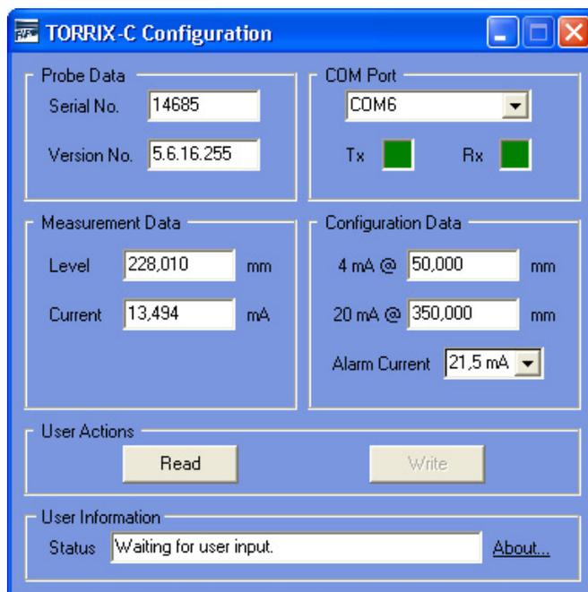
La regolazione dell'assorbimento di corrente in modalità di errore avviene tramite il software di configurazione (vedi figura a sinistra) con l'elenco a discesa "Alarm Current".
