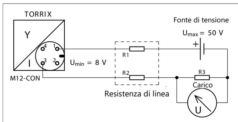
Figura 5: Schema elettrico per TORRIX C
