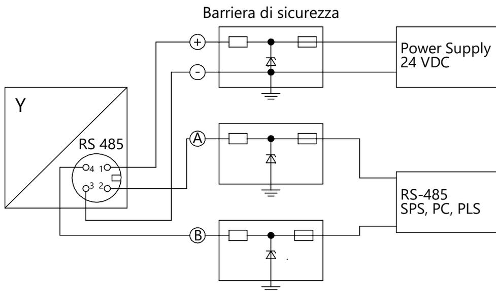
Figura 8: Schema elettrico per TORRIX RS485
