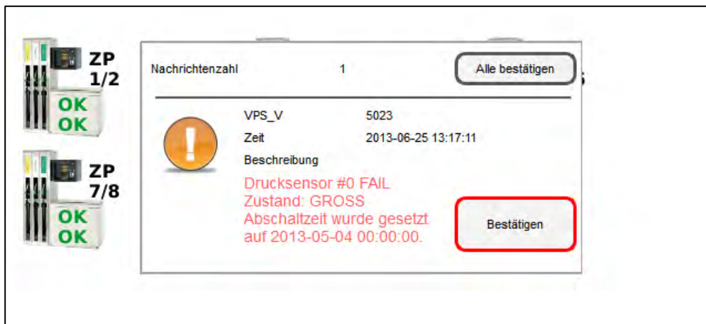
Abb. 17: Alarme und Abschaltung SECON-Vap+ (Bilderserie)
