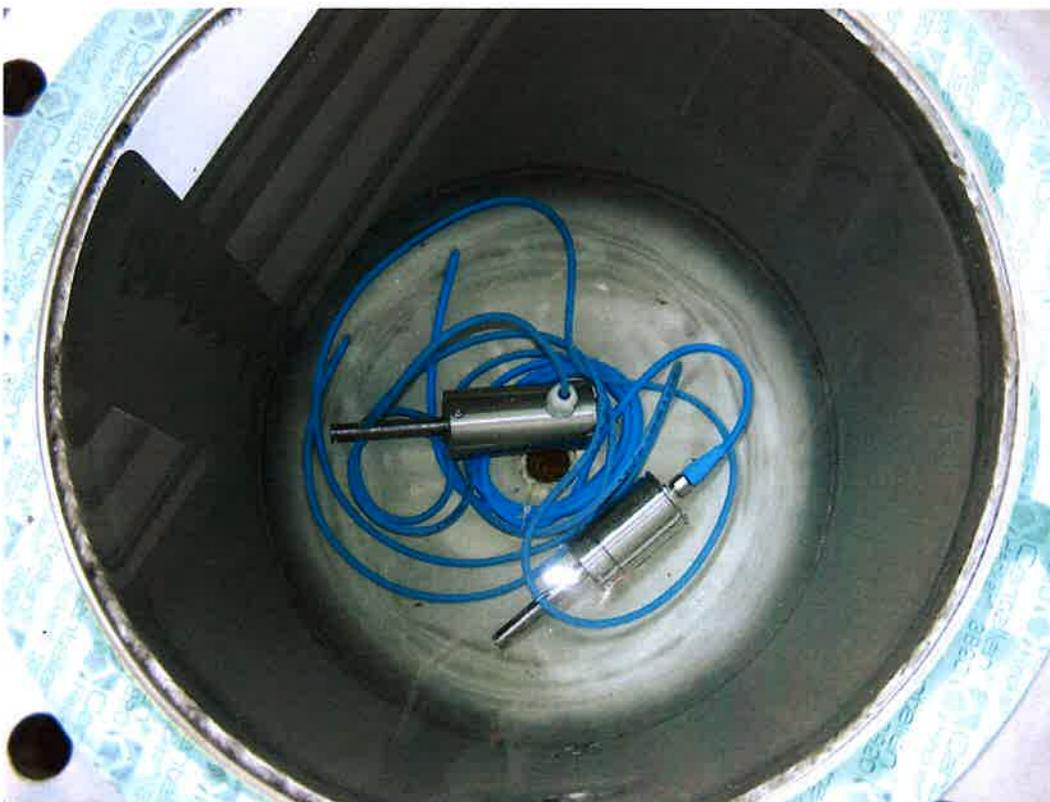
**Bild 4: IPX8 Prüfung**
