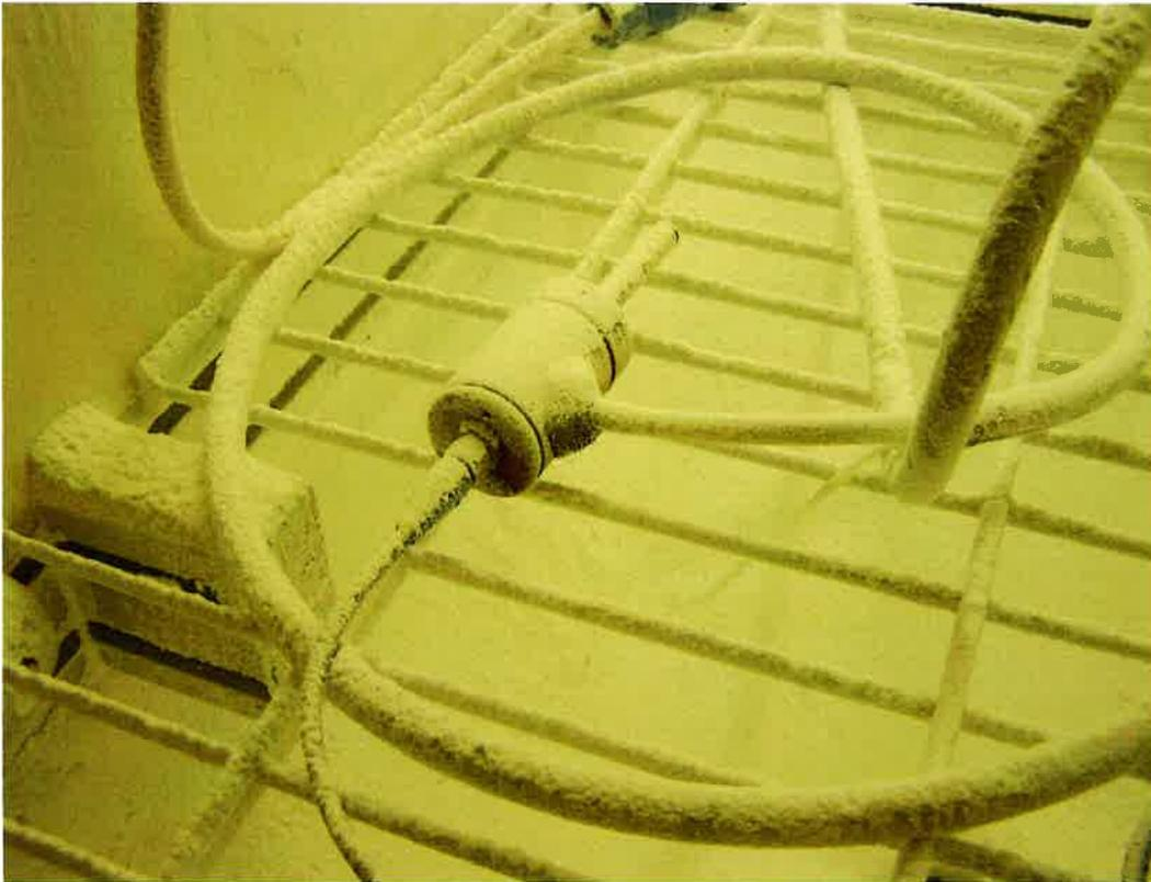
**Bild 3: IP6X Prüfung**
