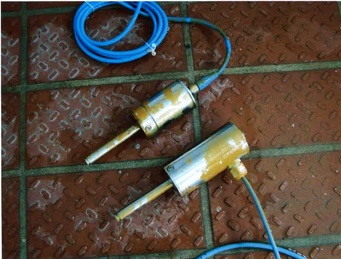
Bild 5: Prüflinge nach IPX8 Prüfung
